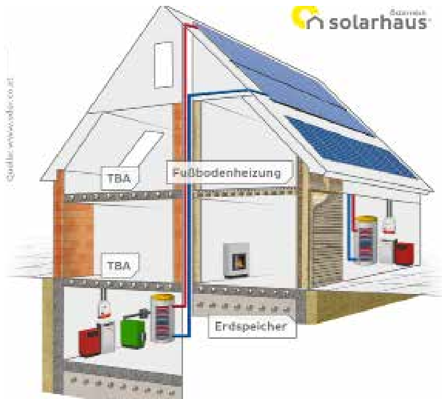
Beim Solarhaus Standard beträgt die solare Deckung des Gesamtwärmebedarfs 70 % bis 100%
